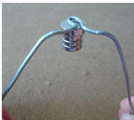
Obr. 5 - Kovová konštrukcia na vloženie neodymových magnetov do dutiny cievky
