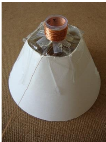
Obr. 4 - Cievka prilepená na membráne
