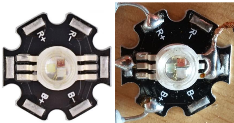
Obr. 1 - RGB LED. Vpravo detail připojení kontaktů.
