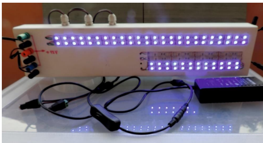
Obr. 10 - Současná verze přístroje (na fotografii je dobře patrné zdvojení modrého barevného kanálu ve zdrojové části panelu)
