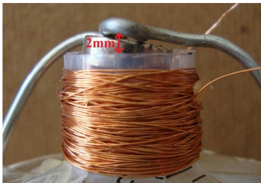
Obr. 6 - Umiestnenie kovovej konštrukcie
